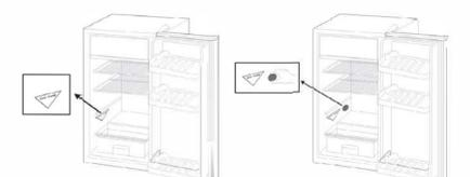
Pour bien positionner l'indicateur de température, il est nécessaire de le coller au même niveau que le symbole "Zone Froide" (voir dessin), en veillant à ce que la surface de la paroi soit parfaitement propre et sèche.
